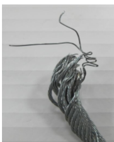
图8钢丝绳断口宏观形貌
