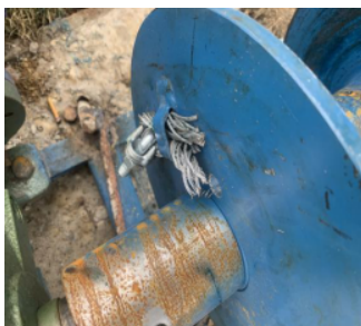
图7断裂钢丝绳固定形貌
