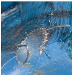
图5通孔外观形貌（内侧）
